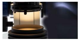
Eine bei der Durchlichtmikroskopie häufig genutzt Lichtquelle ist eine Halogenlampe. Diese ist preisgünstig und bietet abhängig von der Leistung eine hohe Lichtausbeute. Mittels Dimmer kann die für das Objektiv passende Lichtstärke eingestellt werden. Für die meisten Anwendungen ist eine Halogen-Beleuchtung ausreichend.
